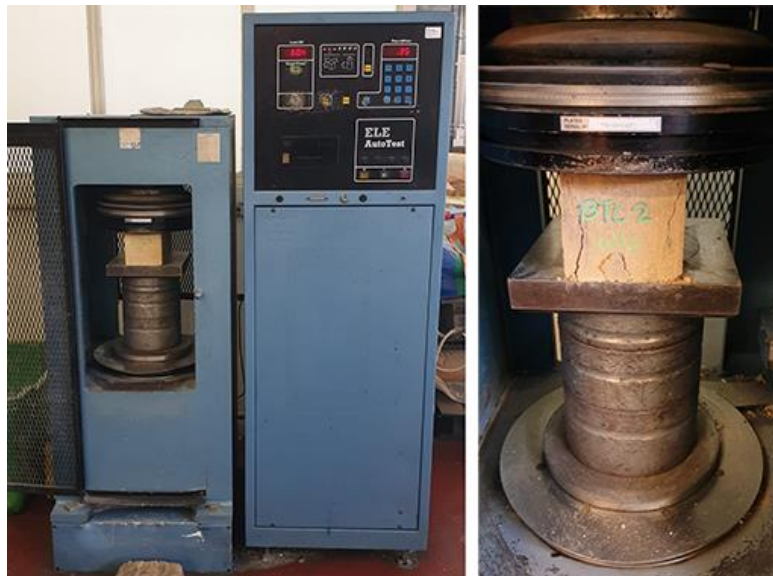
Figura 4.49 - Equipamento compressor usado e BTC ensaiado
