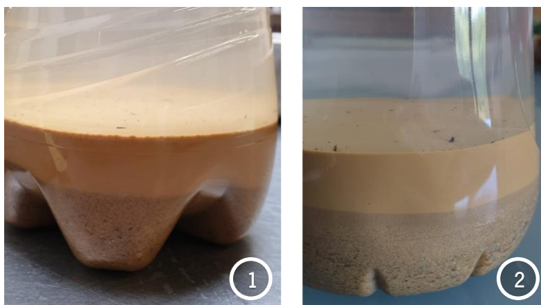
Figura 4.5 – Ensaio de sedimentação simples do solo estudado (1- Resultado do teste de sedimentação após 1h, e 2- após 24h)
