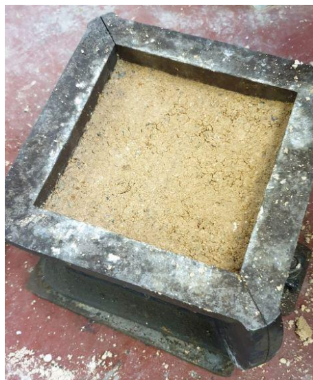
Figura 4.29 - Forma preenchida com solo compactado
