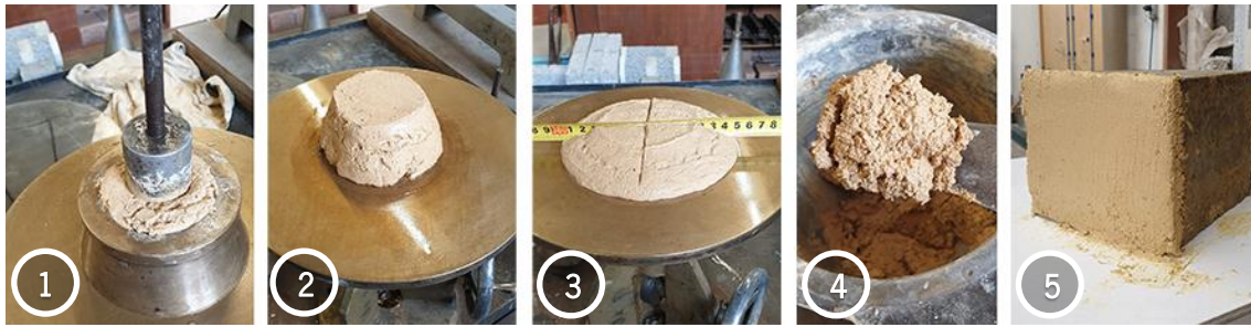
Figura 4.34 – Ensaio de espalhamento e aplicação de argamassa com fibra em provete de taipa (1, 2 e 3- teste de espalhamento; 4- textura da argamassa, e 5- aplicação da argamassa)
