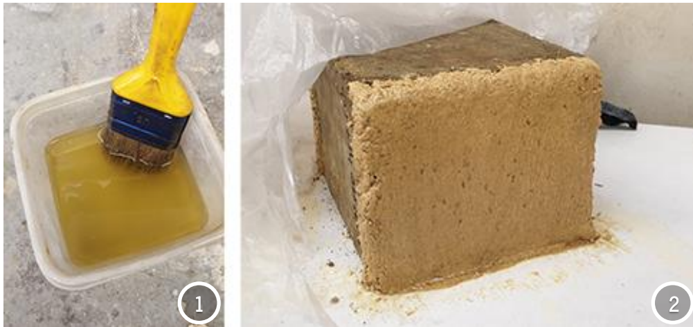
Figura 4.35 – Pintura com óleo vegetal sobre argamassa com fibras
