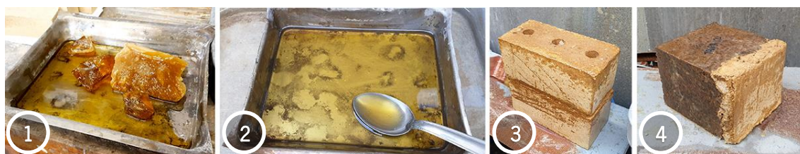
Figura 4.38 - Preparo e aplicação do verniz sobre os provetes (1- Elementos dissolvendo; 2- mistura homogênea; 3 e 4- provetes pintados com o verniz)
