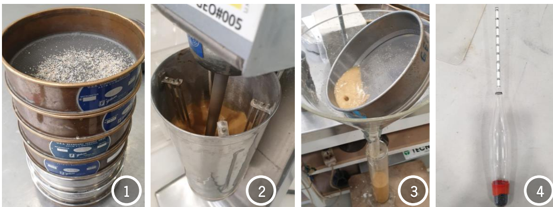
Figura 4.16 - Imagens do processo de ensaio de granulometria por sedimentação (1- Peneiração; 2- mistura da solução; 3- Peneiração úmida, e 4- densímetro)
