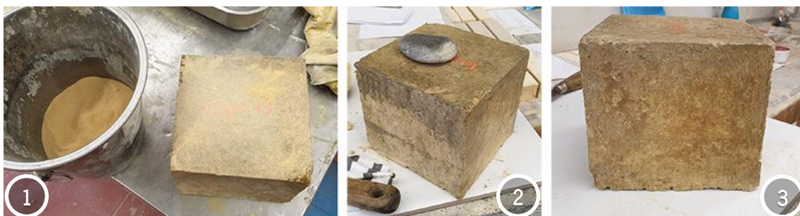
Figura 4.40 – Polimento com pedra sobre provete de taipa com areia fina e com sabão (1 e 2 - polimento com areia finíssima, e 3- resultado do polimento sobre provete de taipa)
