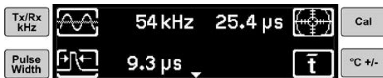
Figura 4.47 - Ajustes do medidor de ultrassom (PROCEQ, 2017)
