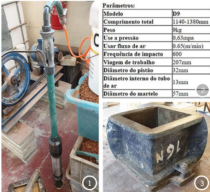
Figura 4.28 – Materiais utilizados na compactação (1- compactador pneumático; 2- ficha técnica do compactado acima, e 3- forma do provete)
