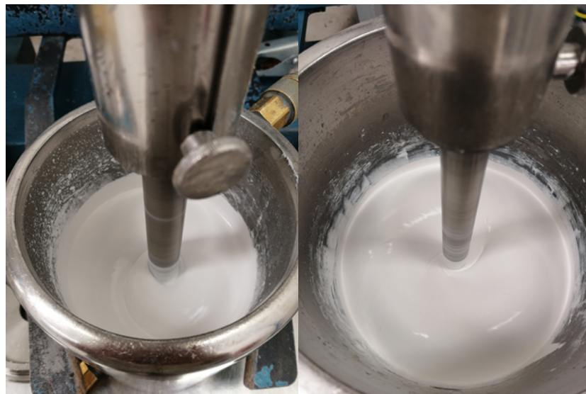
Figura Anexo 6. Ensaio F.4 – 24 m/s, 2 L (esquerda); Ensaio FSU.4 – 24 m/s, 5 L (direita).
