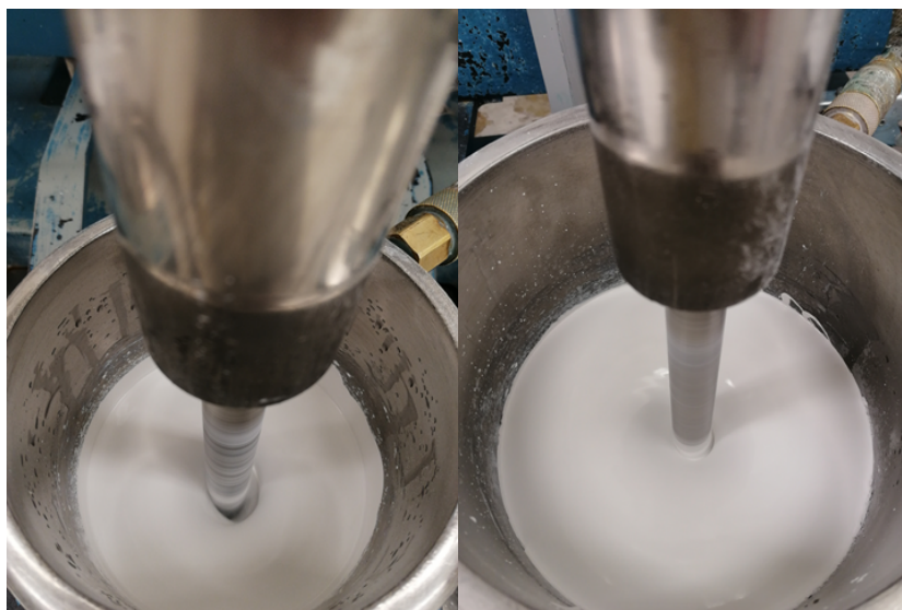
Figura Anexo 1. Ensaio A.2 - 8 m/s, 2 L (esquerda); Ensaio ASU.2 – 8 m/s, 5 L (direita).
