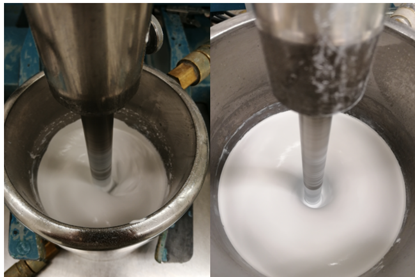
Figura Anexo 4. Ensaio A.5 – 26 m/s, 2 L (esquerda); Ensaio ASU.5 26 m/s, 5 L (direita).
