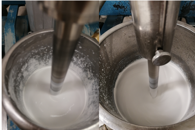
Figura Anexo 5. Ensaio F.3 – 8 m/s, 2 L (esquerda); Ensaio FSU.3 – 8 m/s, 5 L (direita).
