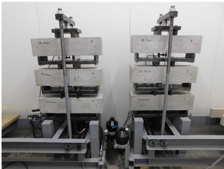
Figura 4. Bastidores de fluência em flexão com vigas pré-fendilhadas
