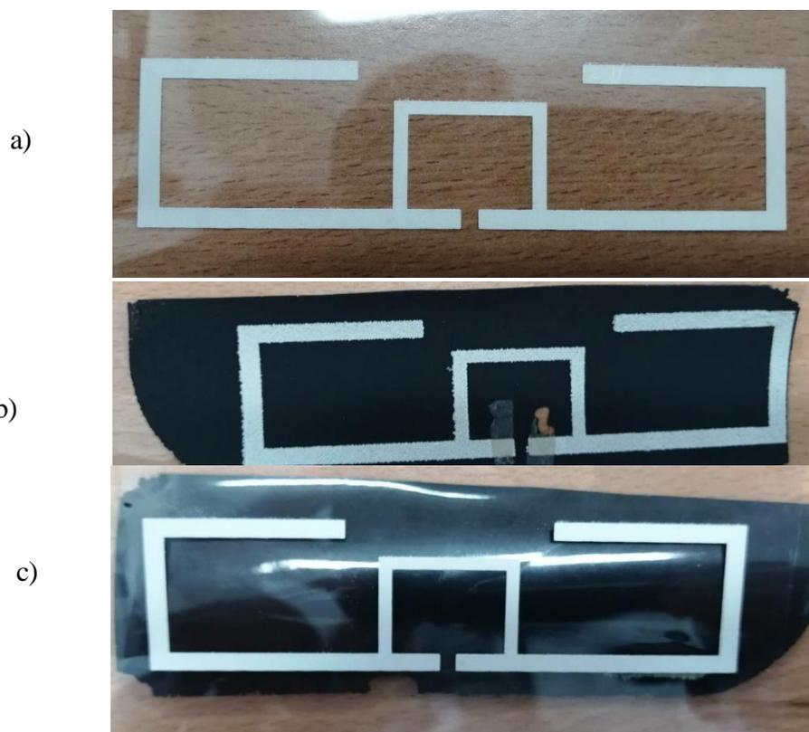
**Figura 46:** Antena dipolo com *loop* indutivo impressa; a) impressão tipo i); b) impressão tipo ii); c) impressão tipo iii).
