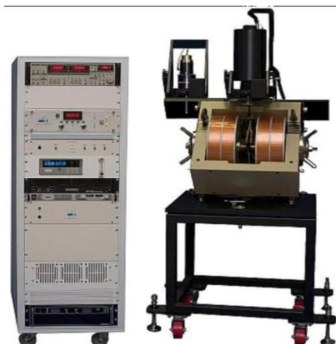
**Figura 31:** Modelo VSM Microsense 10 Mark II utilizado para a medição das propriedades magnéticas dos compósitos ME [92].
