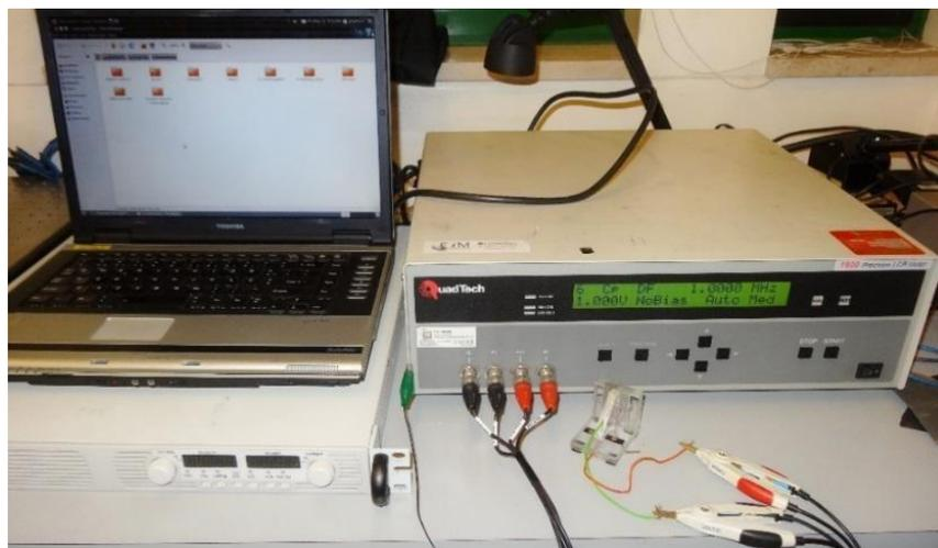
**Figura 28:** Quadtech 1929 Precision LCR meter, utilizado na medição de propriedades dielétricas de uma determinada amostra.
