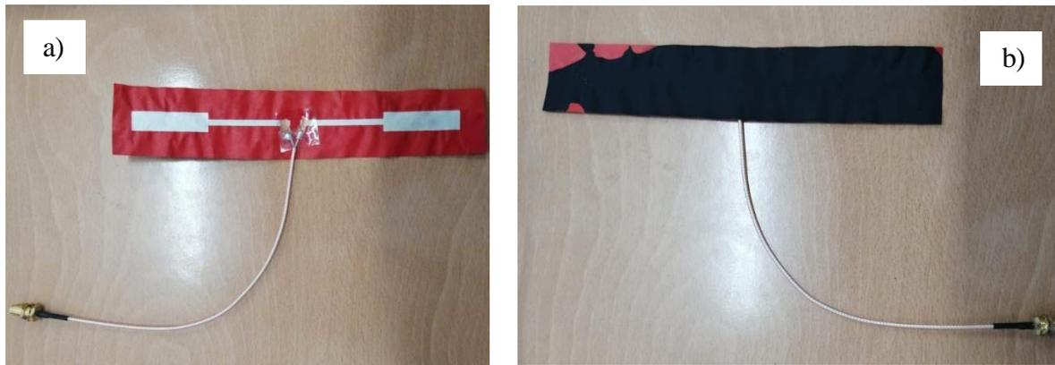
**Figura 55:** Antena dipolo retangular impressa em papel tipo iii); a) parte frontal com a tinta de prata; b) parte inferior da antena com o filme de partículas  $Fe_3O_4$ .
