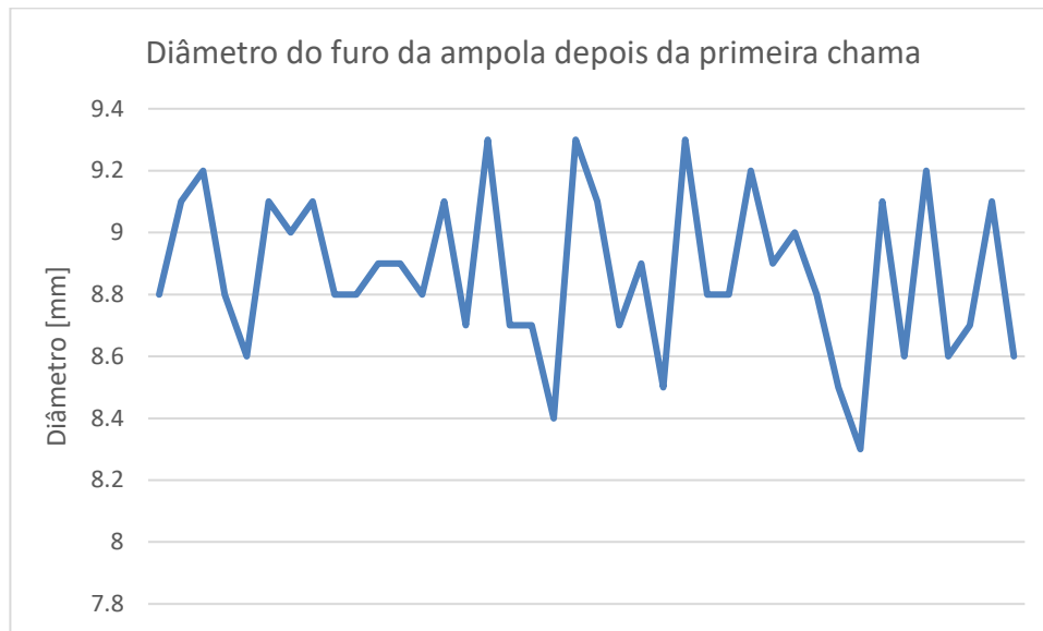
Figura 27 - Variação do diâmetro do furo da ampola na primeira chama
