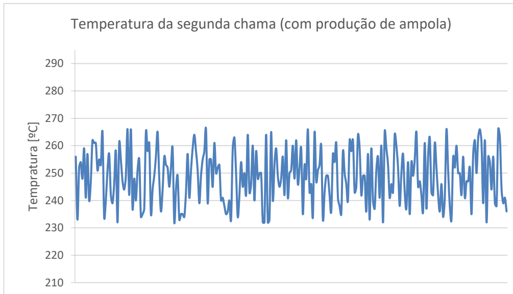
Figura 32 - Variação da temperatura do sensor a atuar na segunda chama com produção de ampola
