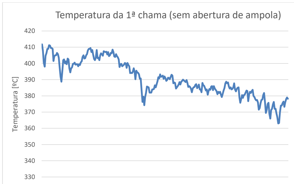
Figura 23- Variação da temperatura da primeira chama ao longo de 45 minutos sem abertura de ampola
