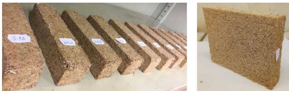
Figura 2 – provetes para ensaios gerais e amostra para condutividade térmica.
