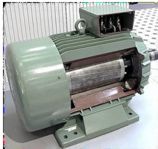
Figura 20 – Motor de indução com estator e rotor [20].
