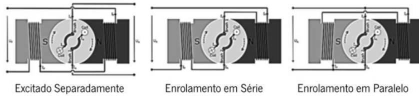
Figura 18 – Visão geral dos três diferentes tipos de motores CC (adaptado de [20]).
