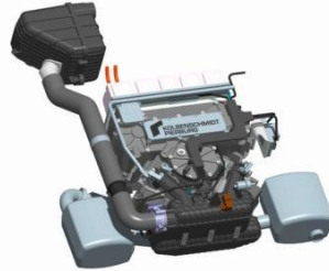
Figura 10 – Vista geral do range extender desenvolvido pela Kolbenschmidt Pierburg – FEV [16].
