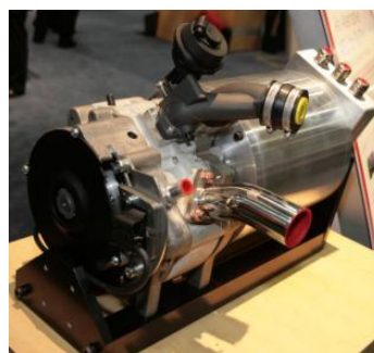
Figura 9 – Range Extender da FEV, com rotor Wankel apresentado no Congresso Mundial de 2009 da SAE [16].
