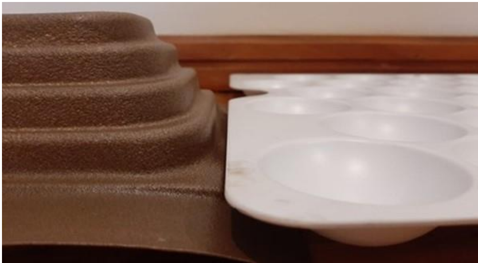
Figura 46 - Peça termoformada com o molde utilizado nesta dissertação (esquerda) e peça termoformada com o molde do projeto Pack2Life.
