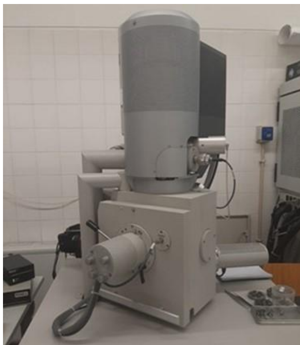
Figura 23 - Microscópio eletrônico de varrimento (FEG/SEM), Nova Nano SEM 200, da marca FEI, do laboratório SEMAT/UM da Universidade do Minho – polo de Azurém.
