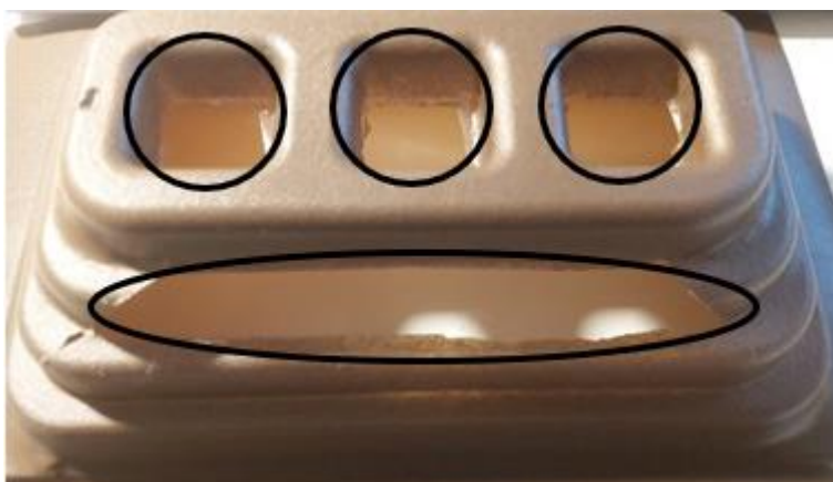
Figura 24 - Zonas rodeadas a preto foram cortadas da peça termoformada e utilizadas para os ensaios de SEM.
