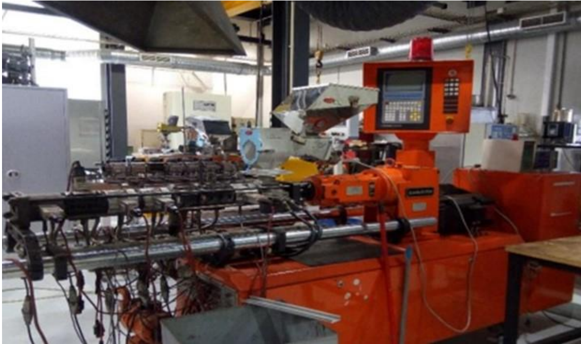
Figura 13 - Extrusora de duplo fuso com movimento co-rotativo Leistriz AG (modelo LSM 34 6 L) do Departamento de Engenharia de Polímeros da Universidade do Minho.
