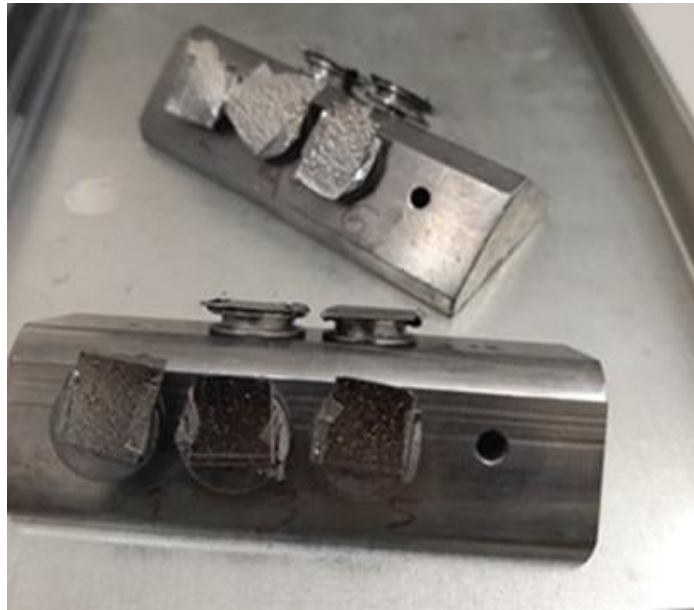
Figura 25 - Amostras colocadas nos pinos com fita cola de dupla face de carbono.
