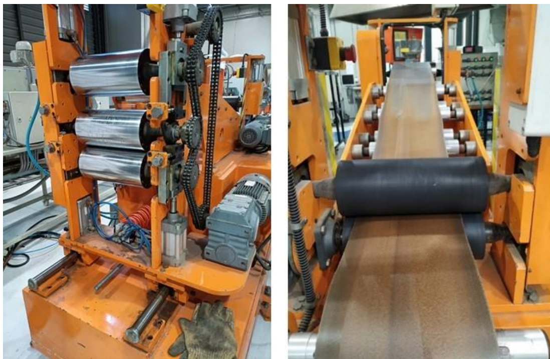
Figura 16 e Figura 17 - Na Figura 16 (esquerda) vê-se a calandra composta pelos rolos de calibração e os rolos de puxo que é acoplada à máquina de extrusão; na Figura 17 (direita) vê-se o material a passar pelos rolos de puxo, ganhando a largura que se pretendeu para termoformar.
