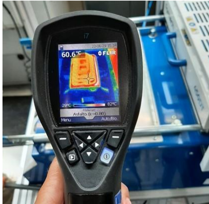
Figura 31 - Câmara Termográfica FLIR utilizada para captar imagens e medir a temperatura das folhas no momento da termoformação.
