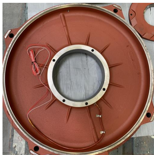
Figura 28 - Instalação de PT's
