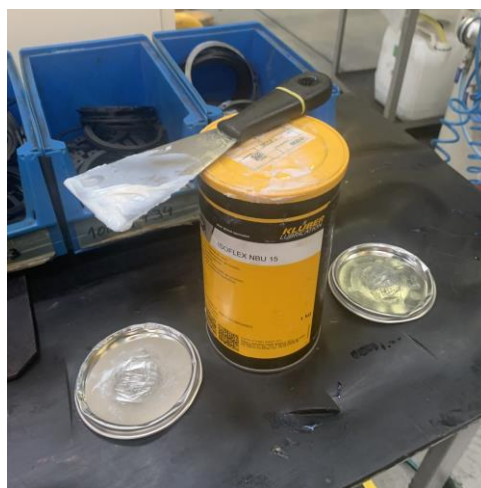
Figura 45 - Modo de aplicação de massa especial
