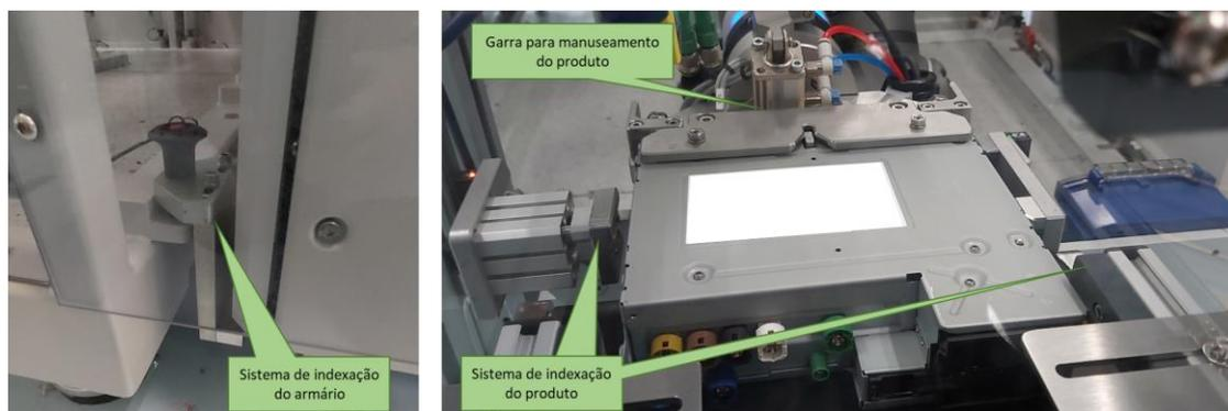
Figura 39 – Mecanismo de indexação rápida de sistema de programação e de produto
