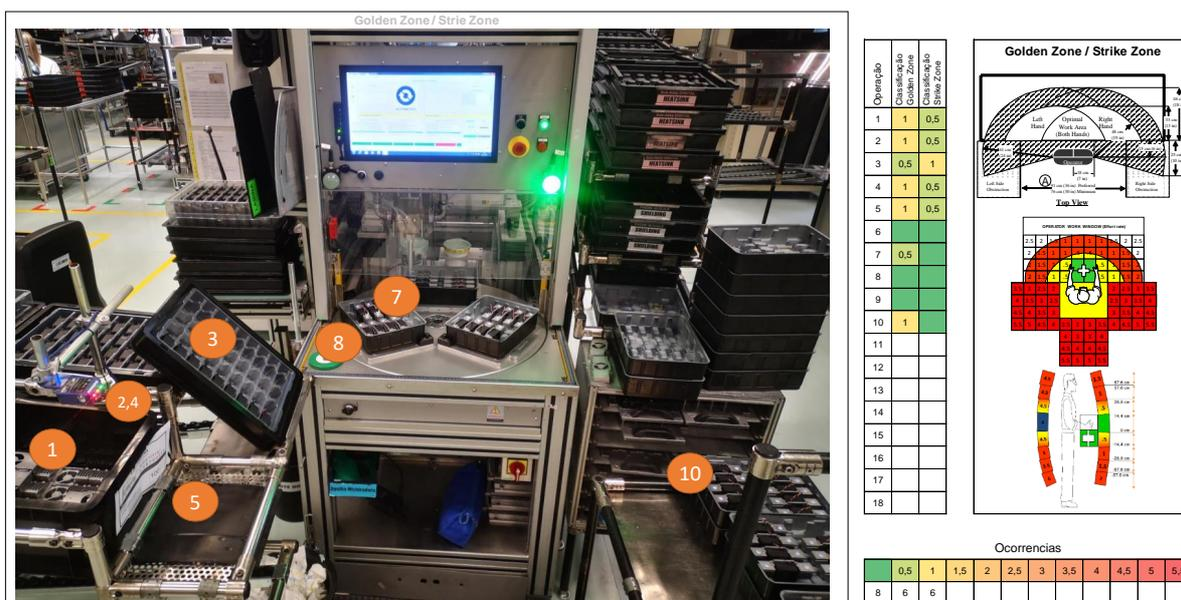
Figura 54 – Avaliação de risco ergonómico do posto de *Gap Filler* CBA
