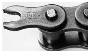
Rotura de placa
