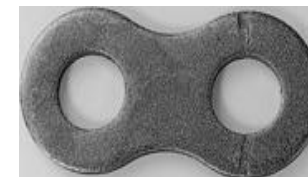
Fissura de placa
