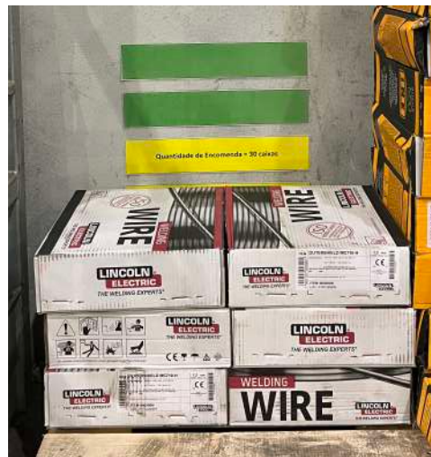
Figura 32. Exemplo da implementação do sistema de gestão visual no fio de soldadura.
