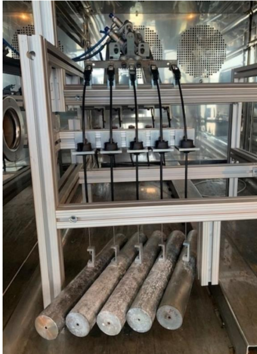
Figura 34 - Estrutura utilizada na realização do ensaio de fadiga
