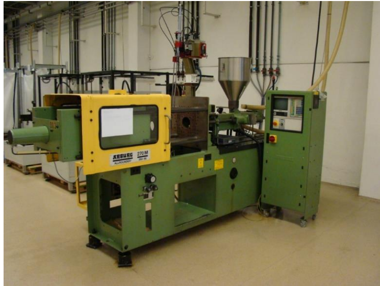
Figura 17 - Máquina de injeção ARBURG ALLROUNDER 270M 350-90
