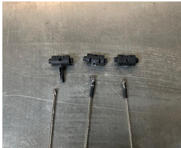
Figura 37 - Diferenças nos modos de falha dos terminais consoante o diâmetro da flor no interior
