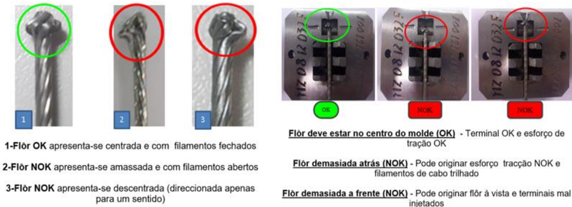
Figura 18 - Manual de Qualidade da Ficosa: a) Flor OK; b) Posicionamento da flor no molde
