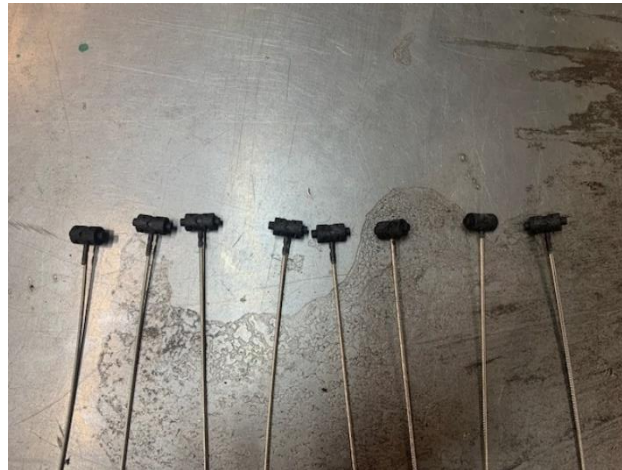
Figura 25 – Peças obtidas durante o estudo de balanceamento do molde
