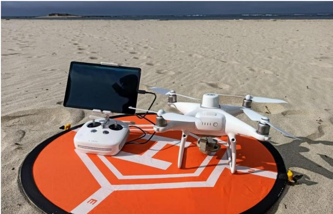
**Figura 20.** VANT modelo DJI Phantom 4 RTK utilizado para captura da fotografia aérea, com o apoio tablet Android onde foi manuseado o software DJI Pilot.
