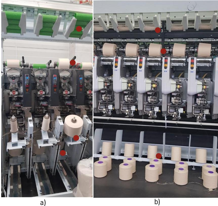
Figura 24 - Bobinadeira com dois pratos (a) e bobinadeira com apenas um prato (b)
