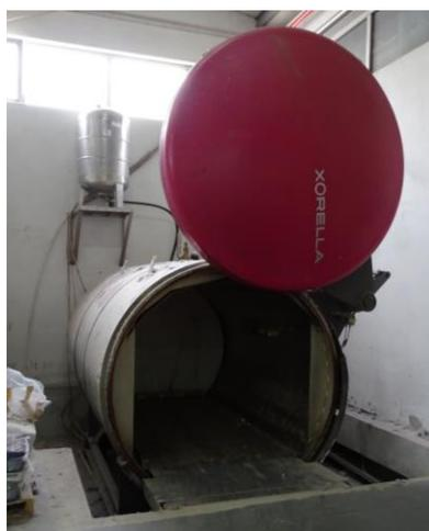
Figura 18 - Fotografia da vaporizadora
