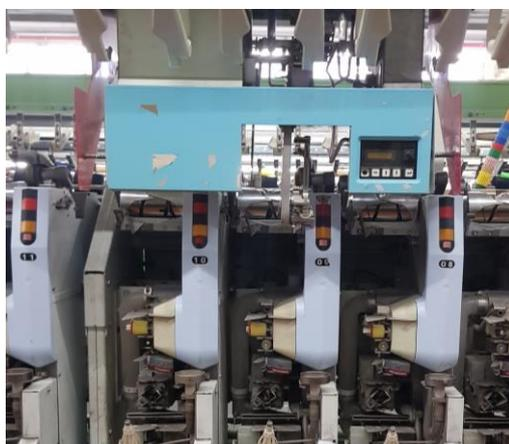
Figura 26 - Robô que realiza a troca automática de bobines
