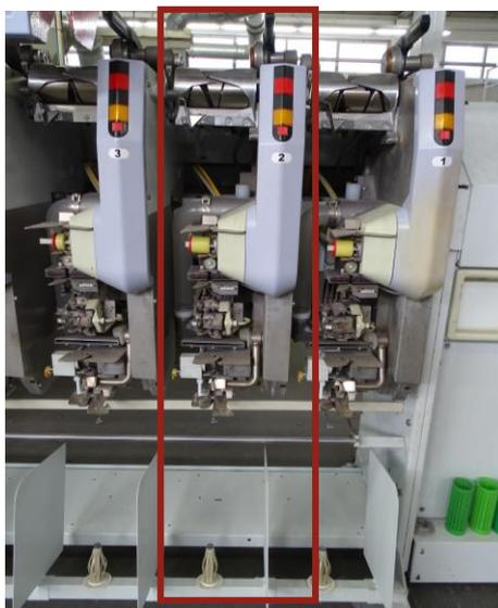
Figura 17 – Fuso de uma bobinadeira
