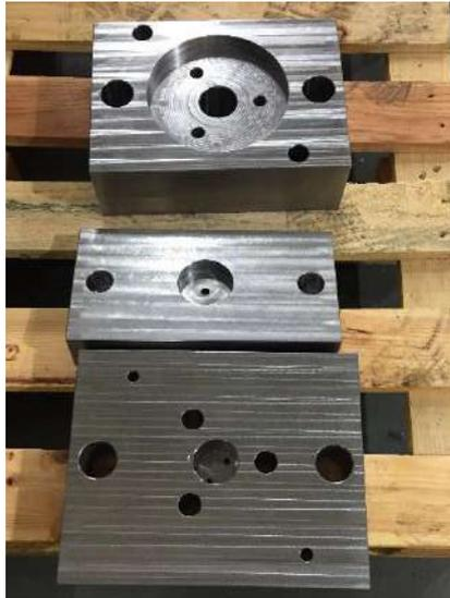
Figura 5.9 - Placa superior, placa inferior e base.
