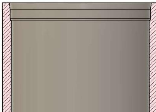
Figura 3.12 - Deformação obtida na extremidade superior através de forjamento.
