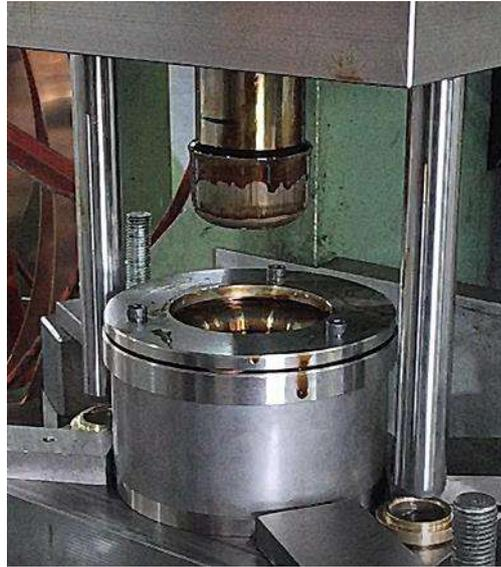
Figura 6.2 - Peça presa ao punção de estampar na posição de recuo.
