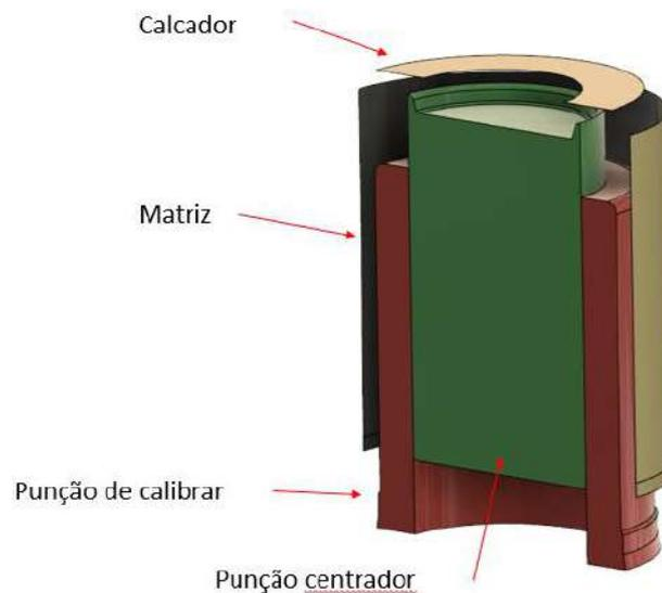
Figura 4.13 - Ferramentas para extrudir a extremidade superior da taça.
