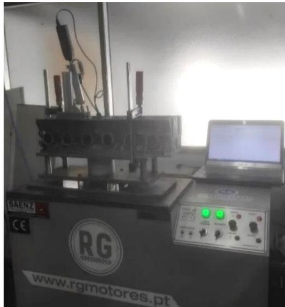
Figura 48 - Culassa montada no fluxómetro utilizado nas medições.
