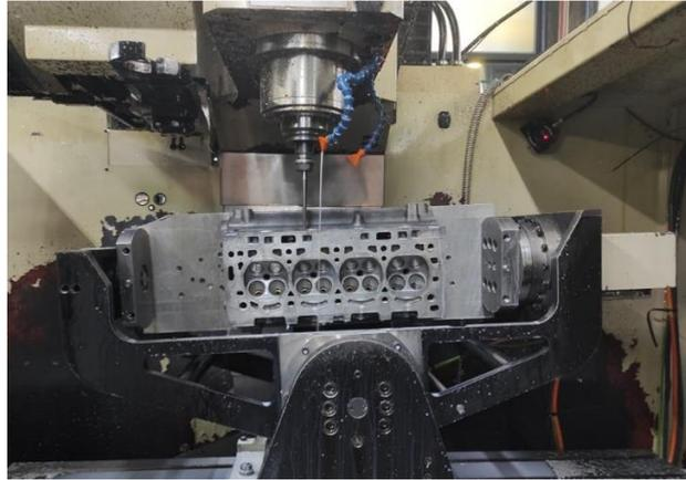
Figura 47 - Funcionamento da máquina CNC, Rottler F69ATC, num outro motor.
