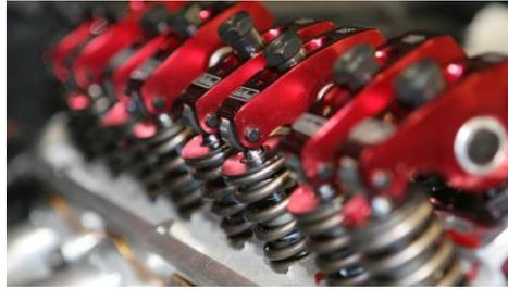
Figura 34 - Molas helicoidais utilizadas em motores de combustão interna [36].
