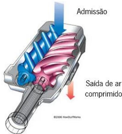
Figura 18 - Funcionamento do compressor do tipo parafuso (Adaptado de [15])
