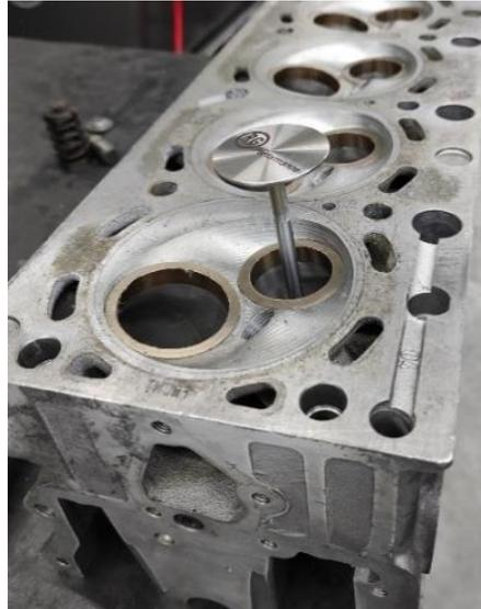
Figura 45 - Válvula de escape fabricada na Rectificadora de Guimarães para implementação no motor otimizado.
