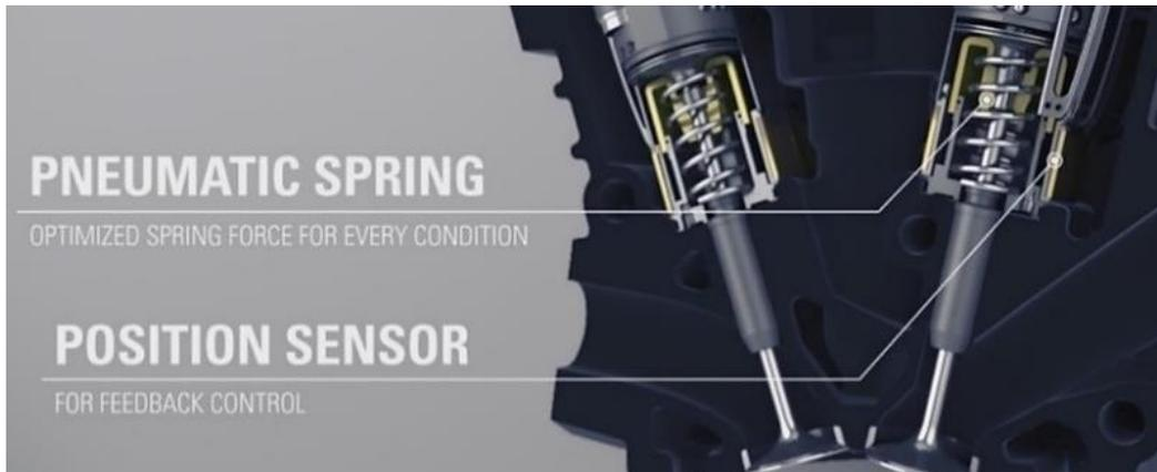
Figura 11 - Sistema *FreeValve*. (adaptado de [10])
