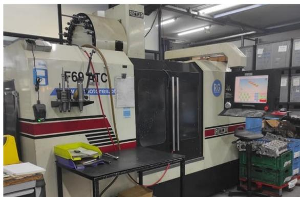
Figura 46 - Máquina CNC, Rottler F69ATC, utilizada para a medição das condutas.
