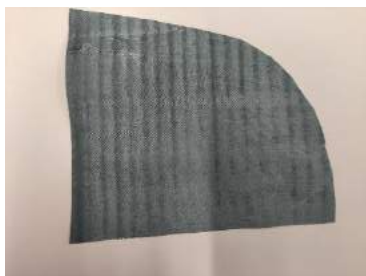
Figura 7: Tecido revestido com hidrolisado de couro e top coat crack
