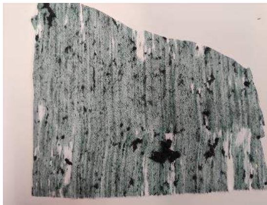
Figura 6: Tecido com coating de resíduos de couro com imperfeições
