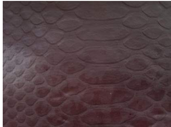
Figura 10: Malha revestida com hidrolisado de couro castanho com embossing
