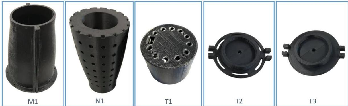
Figura 57 – Representação dos moldes reais de 2 unidades M1, 1 unidade N1 e 1 unidade das peças T.
