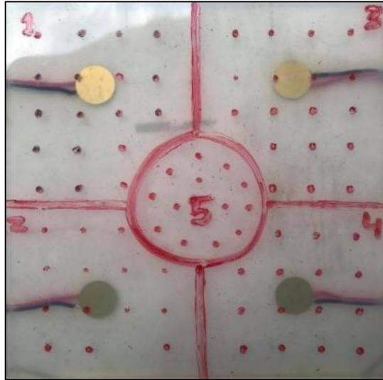
Figura 83 – Manga de teste com os sensores piezoelétricos dividida em 5 secções.
