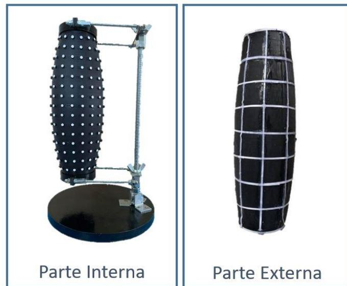
Figura 59 – Parte interna e externa da manga de calibração em ambiente real.
