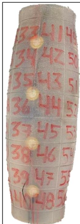
Figura 95 – Manga de teste final com os sensores piezoelétricos.
