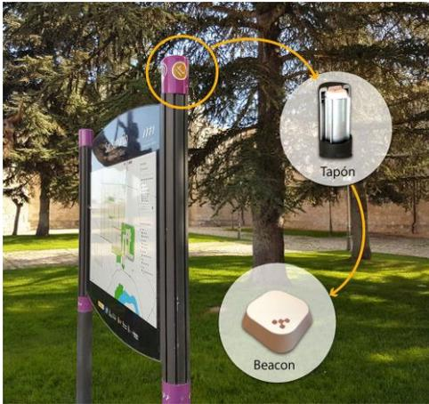
Figura 147 – Exemplo de sistema com beacon.
