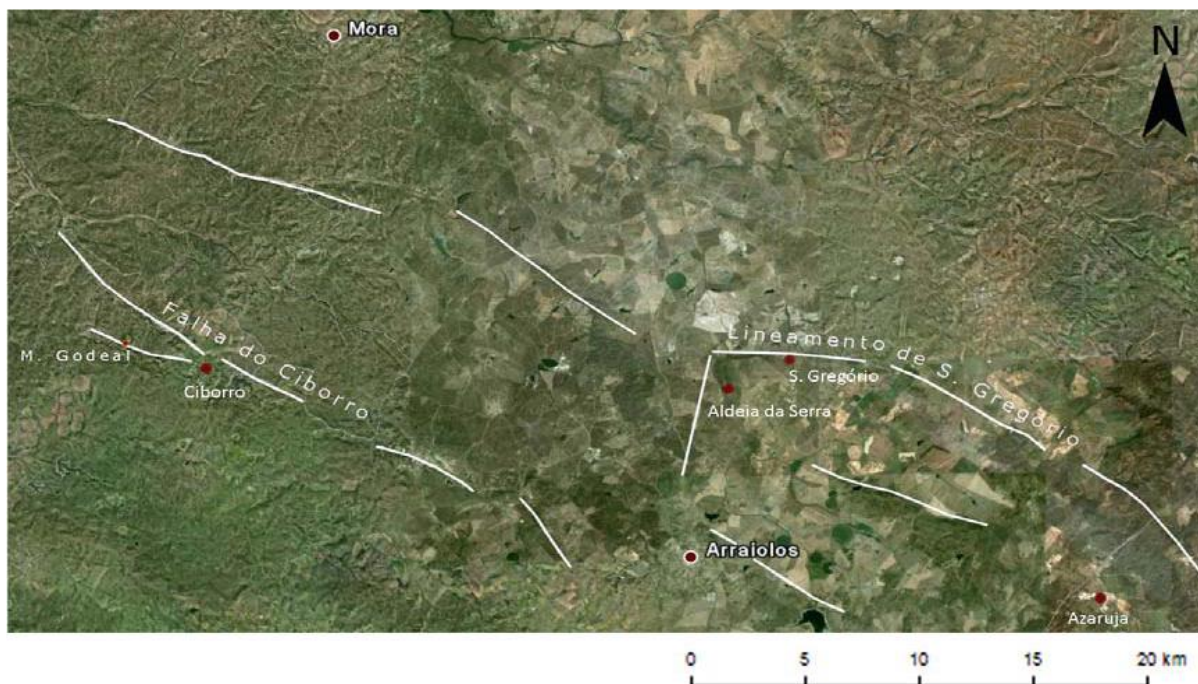
Figura 62. Principais lineamentos da região estudada, observáveis em imagem de satélite (Araújo et al., 2010).
