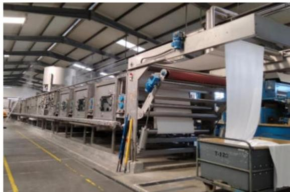
*Figura 9: Máquina de branquear - Estamparia Têxtil Adalberto Pinto da Silva S.A.. (Fotografia de fonte própria).*
