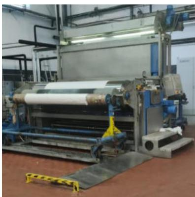
**Figura 12:** Máquina de tingimento foulard - Estamparia Têxtil Adalberto Pinto da Silva S.A.. (Fotografia de fonte própria).
