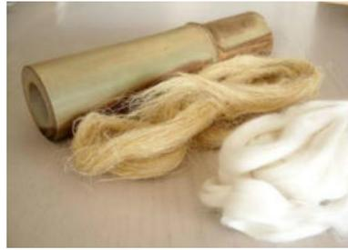
**Figura 7:** Caule da árvore do bambu a fibra da viscose e a mesma após operações de preparação artificial (retirado de <sup>24</sup>).
