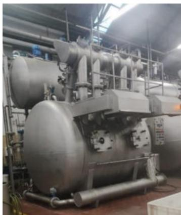
**Figura 11:** Máquina de tingimento jet - Estamparia Têxtil Adalberto Pinto da Silva S.A.. (Fotografia de fonte própria).
