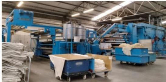
*Figura 18: Máquina de sanforização - Estamparia Têxtil Adalberto Pinto da Silva S.A.. (Fotografia de fonte própria).*
