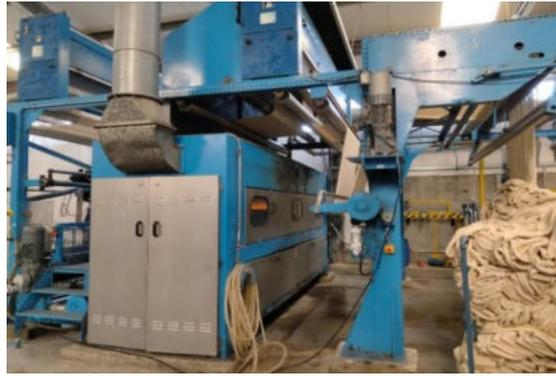
*Figura 8: Máquina de gasear - Estamparia Têxtil Adalberto Pinto da Silva S.A.. (Fotografia de fonte própria).*
