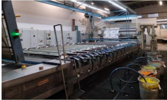
*Figura 13: Máquina de estampar ao quadro rotativo - Estamparia Têxtil Adalberto Pinto da Silva S.A.. (Fotografia de fonte própria).*
