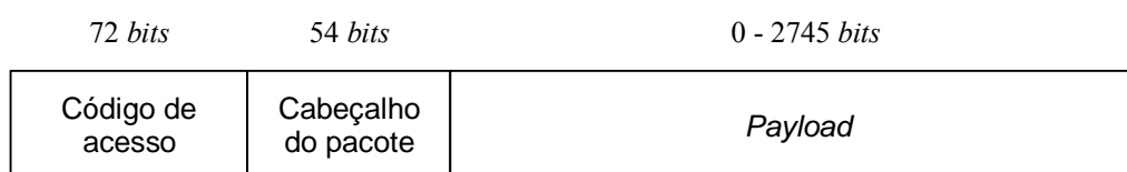
Figura 3.7: Formato do pacote do Bluetooth.
