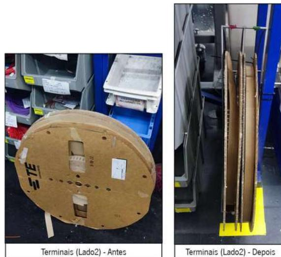
Figura 40 - Bobines de terminais do Lado 2: antes e depois
