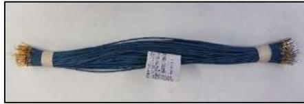
Figura 17 - Output da máquina de corte (maço de fios cortados com terminais)
