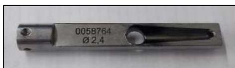
Figura 35 - Bico para fio na máquina de corte
