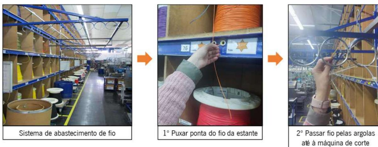
Figura 38 - Sequência do abastecimento de fio
