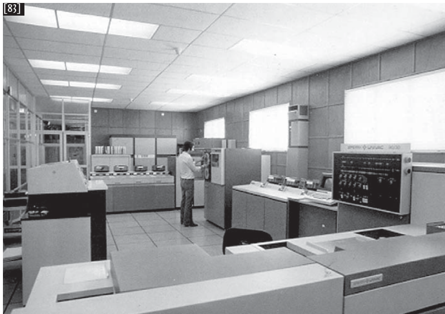
[83] Fotografia da sala do Centro de Tratamento da Informação da CUF/QUIMIGAL no perímetro das Fábricas do Barreiro em 1983 – Computador UNIVAC 90/30.
