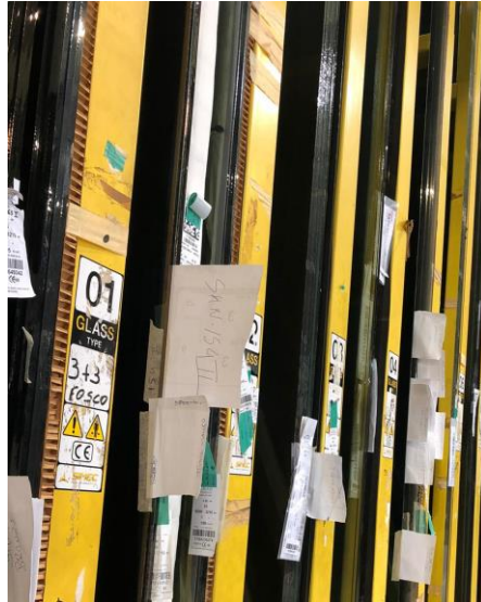
Figura 18 - Exemplo de identificação das chapas de vidro, na seção de vidro monolítico
