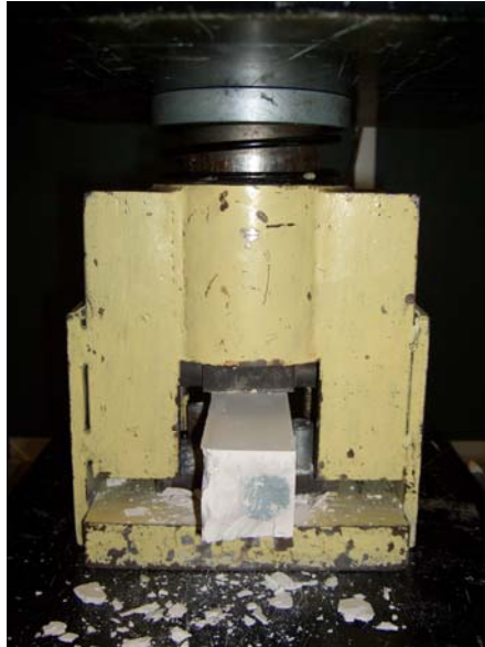
Figura 4 – Ensaio de compressão das caldas de injeção
