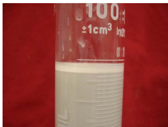
Figura 3 – Ensaio de exsudação de uma calda
