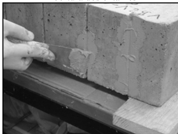
Preenchimento do entalhe com o adesivo
