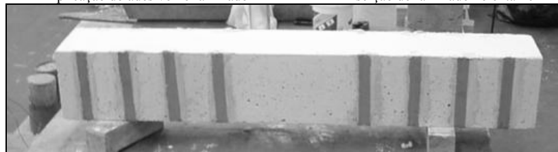
Aspecto final da viga após a execução do reforço
