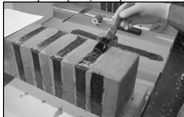
Aplicação da camada de resina no betão
