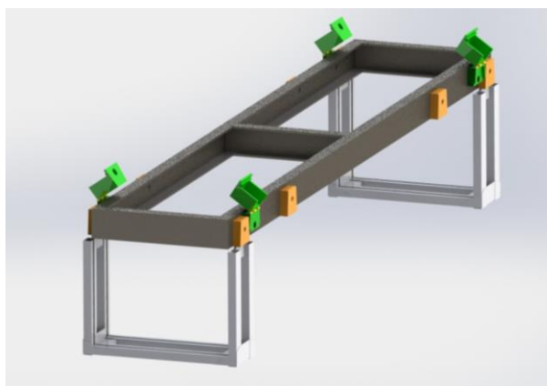
Figura 4.12 – Modelação 3D - CAD da solução das dobradiças com racks de armazenamento
