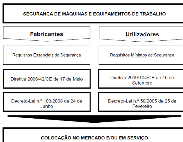
Figura 3.6 – Enquadramento legislativo para máquinas e equipamentos de trabalho para fabricantes e utilizadores adaptado de [13]
