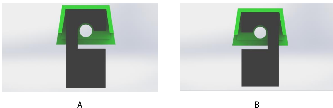
Figura 4.5 – Caixas de alinhamento para cestos de extrusão
