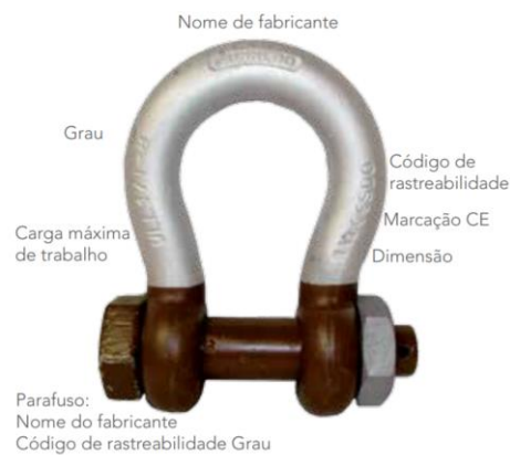
Figura 3.10 – Exemplo de uma manilha com certificação CE adaptado de [18]
