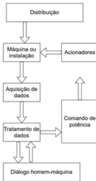
Figura 3.2 – Representação da interligação entre os vários elementos de um sistema automatizado adaptado de [5]
