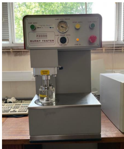
Figura 15: Equipamento utilizado para a realização do teste de rebentamento.
