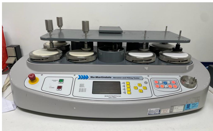
Figura 14: Equipamento utilizado para a realização do teste de abrasão e do teste de resistência à formação de pilling.
