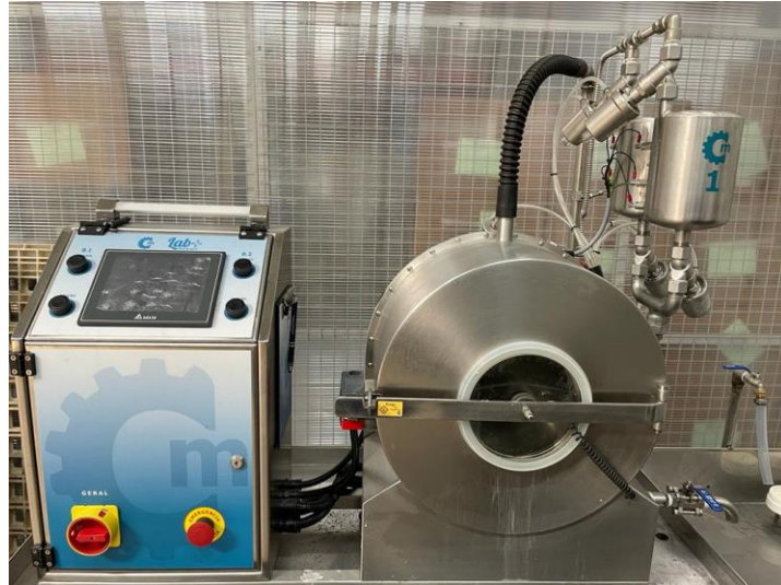
Figura 13: Equipamento utilizado na aplicação do biopolishing .
