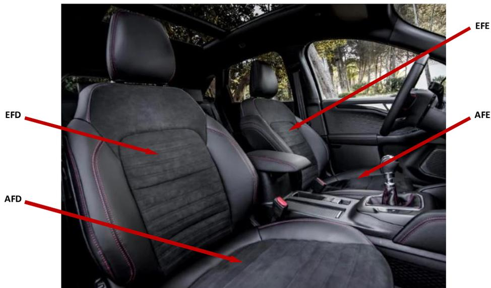
Figura 9: Constituição da parte dianteira do modelo *Ford Kuga*
