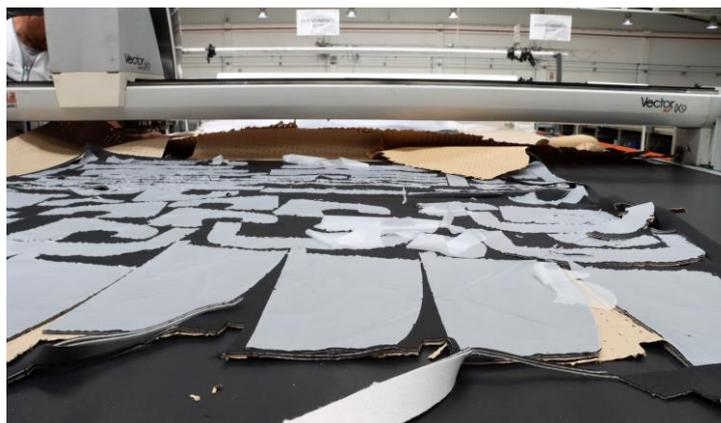
Figura 12: Máquina automática de corte de tecido – *Lectra*
