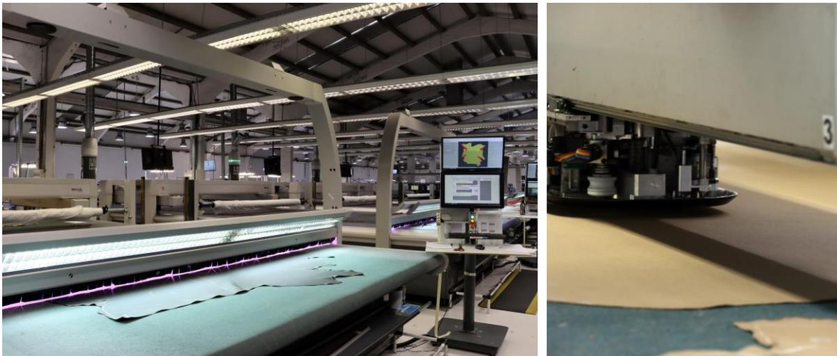
Figura 13: Máquinas automáticas de corte de couro – *Versallis* – e respetiva cabeça cortante
