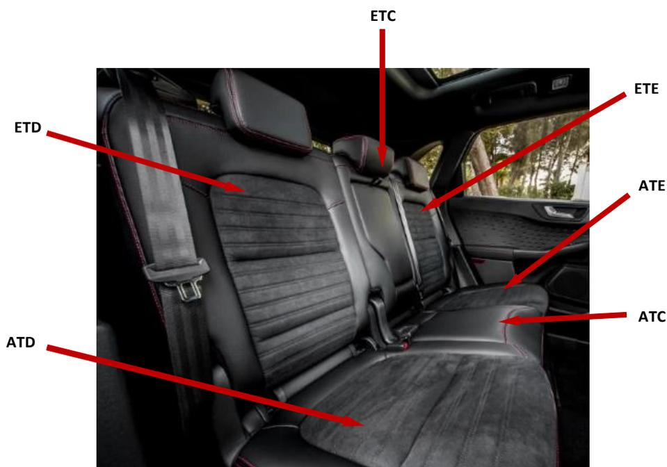
Figura 10: Constituição da parte traseira do modelo *Ford Kuga*
