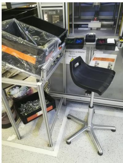
Figura 32 – Local não ergonômico das caixas das claws
