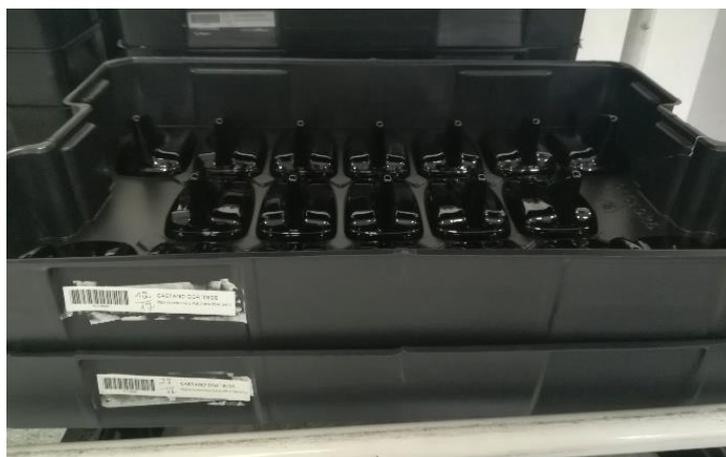
*Figura 35 – Mau acondicionamento dos copos das antenas*
