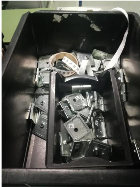
*Figura 46 – Mau acondicionamento das bases*
