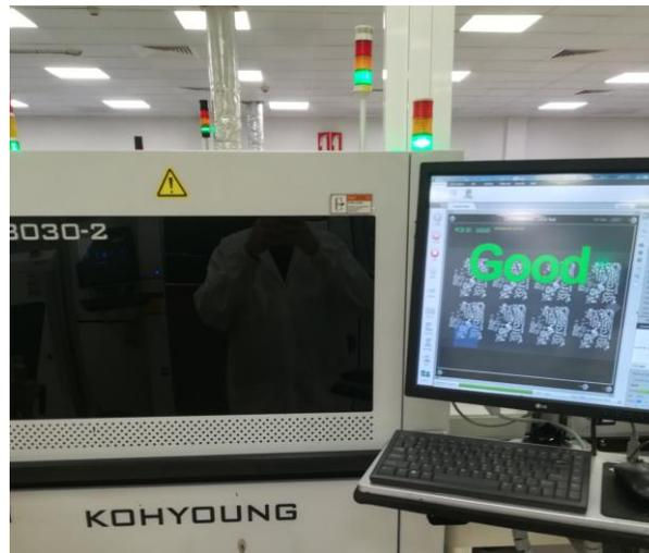
*Figura 22 – Inspeção da pasta de solda numa linha SMT*
