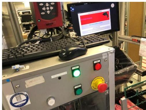
*Figura 31 – Posição do teclado dificultava o acesso às caixas com gaskets*
