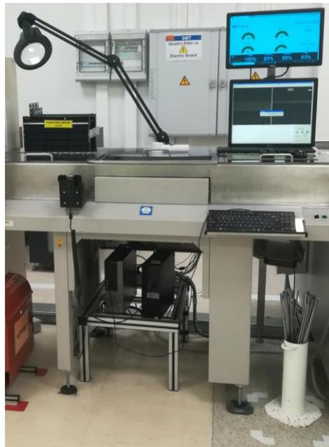
*Figura 25 – Máquina AOI de uma linha SMT*
