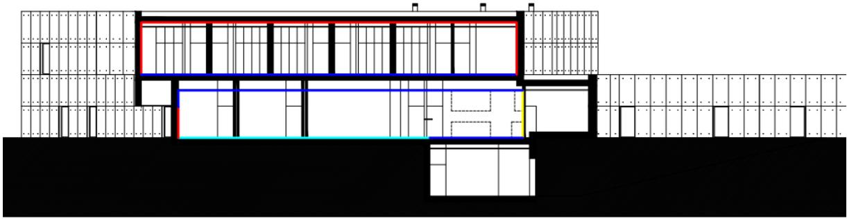
Figura 71 - Marcação da envolvente, corte C2
