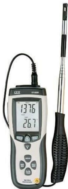
Figura 33 - Anemómetro de fio quente
