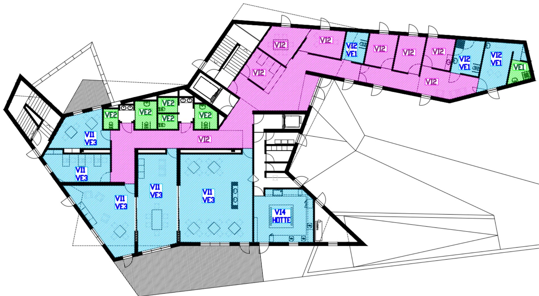
Figura 84 - Espaços com ventilação (insuflação, extração ou mista) no piso 0
