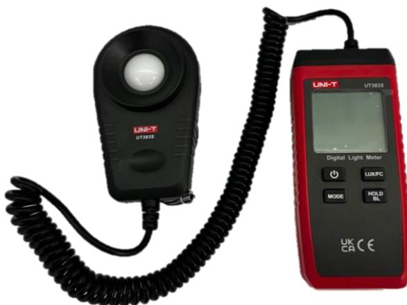
Figura 42 – Luxímetro usado nas medições
