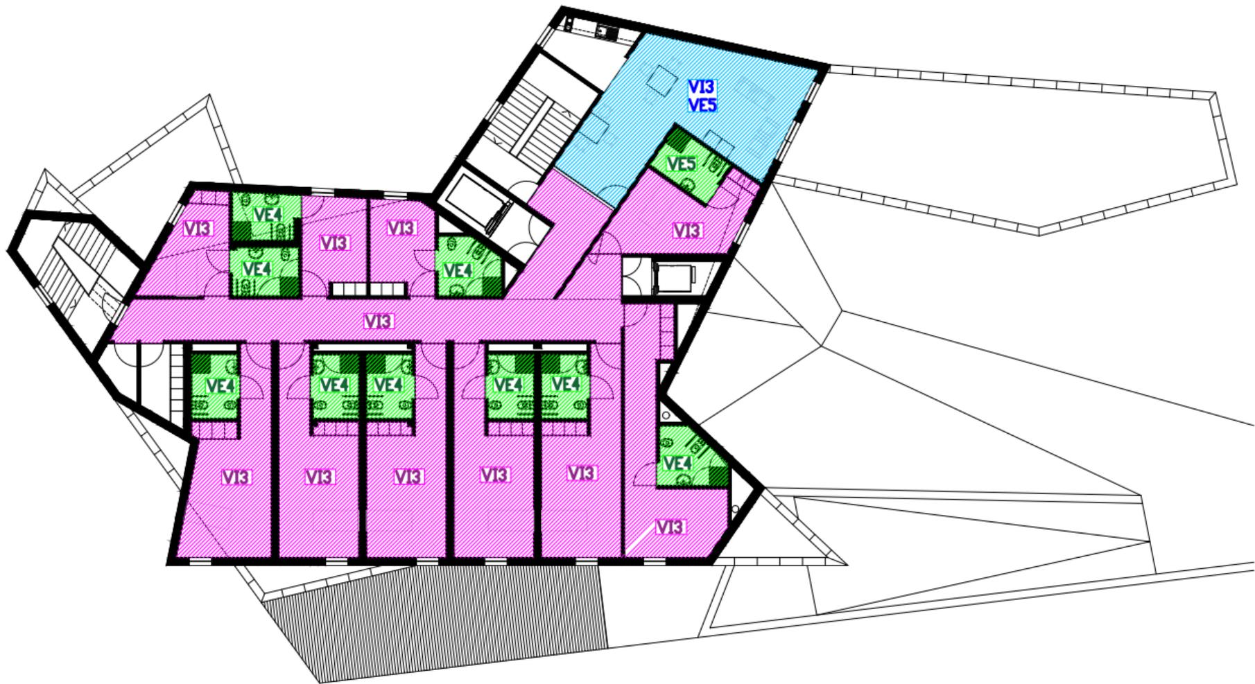
Figura 85 - Espaços com ventilação (insuflação, extração ou mista) no piso 1
