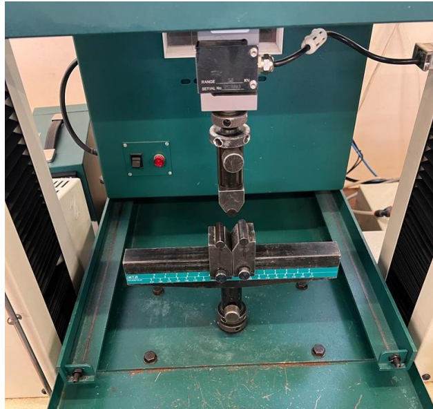
Figura 7.15 - Equipamento utilizado para a testagem, com os apoios e a célula de carga adequados já montados.
