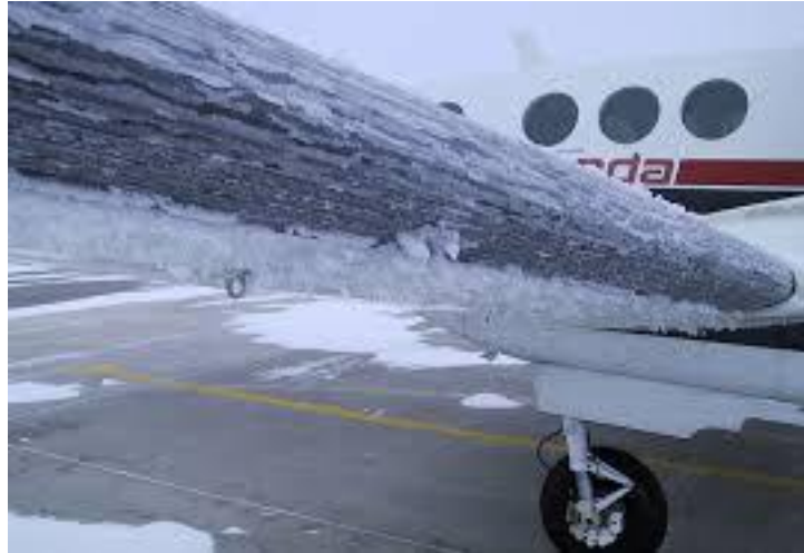
Figura 4.10 - Acumulação de gelo na asa de um avião [43]
