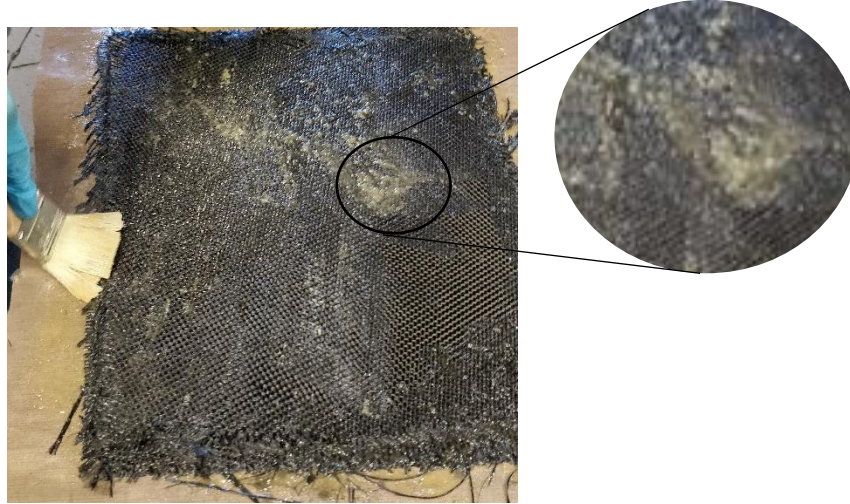
Figura 6.3 - Formação de grumos de STF na impregnação, após a sua incorporação na matriz de forma manual.
