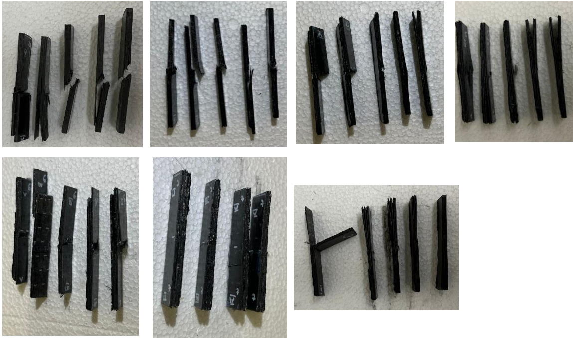
Figura 7.13 - Resultados laterais das amostras após o ensaio de Charpy (provetes 2 até ao 8 da esquerda para a direita)
