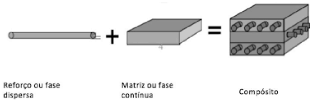
Figura 3.1 - Esquemática de um material compósito com os seus constituintes [17].
