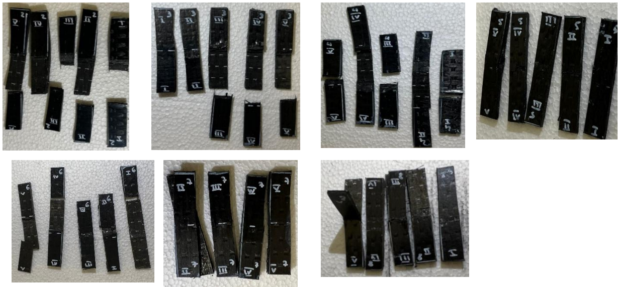
Figura 7.12 - Resultados frontais das amostras após o ensaio de charpy (provetes 2 até ao 8 da lendo-se da esquerda para a direita)
