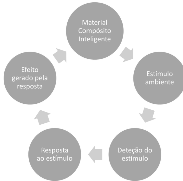
Figura 4.2 - Esquemática do comportamento de um material compósito inteligente.
