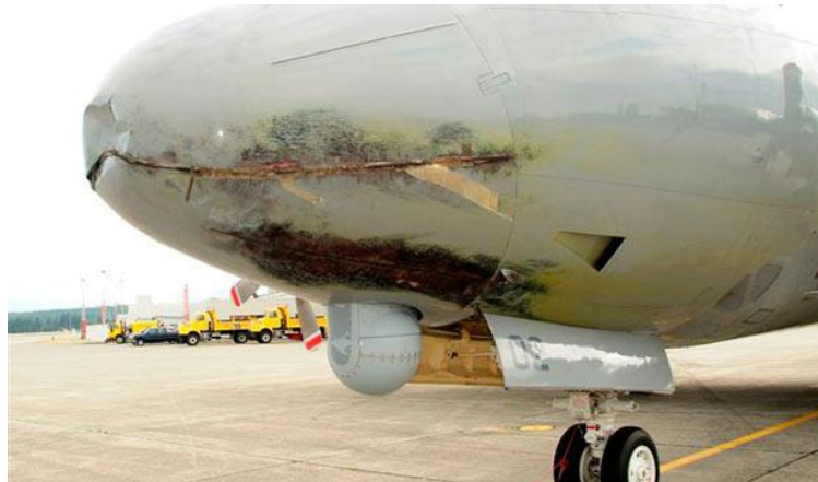
Figura 4.9 - Exemplar de um avião atingido por raios [42].
