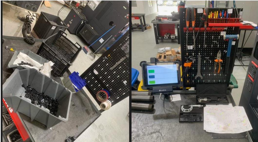
Figura 18 - Antes e depois da aplicação 5S na bancada de trabalho dos operadores
