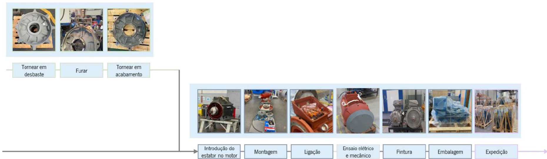
Figura 50 - Esquema simplificado do processo produtivo geral de um motor
