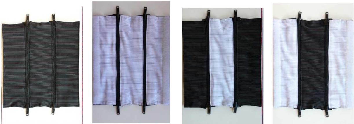
Figuras 50, 51, 52 e 53: Combinação dos lados UsAzU com o sistema de fecho de correr injectado, com dois cursores reversíveis e divisíveis em ambos os lados.
