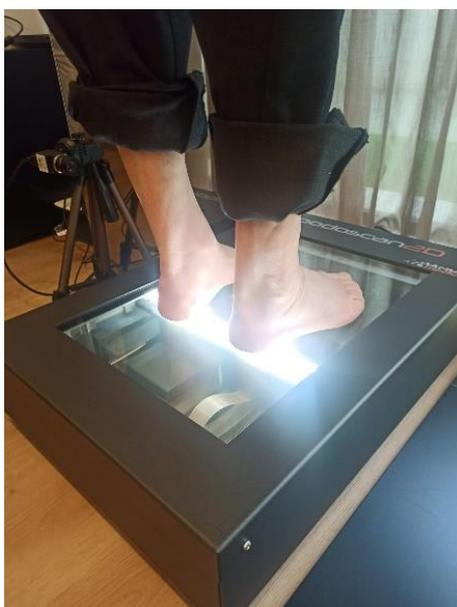
Figura 42- Processo de recolha do scan 2D
