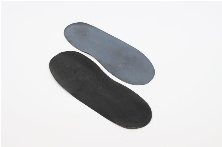
*Figura 49 – Resultado do fabrico aditivo da base*
