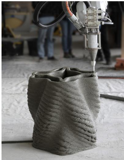
**Figura 5.2.2.** Fotografia aproximada da impressão de uma das colunas do projeto.
