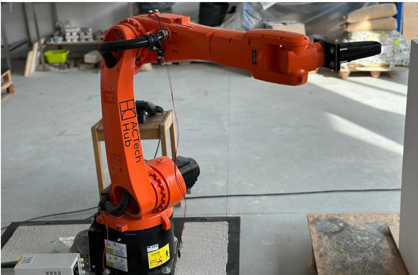
**Figura 3.3.3.** Foto do robô KUKA KR10 R1440-2 nas instalações do Arena, Advanced Design & Technology Lab da Universidade do Minho em Azurém.
