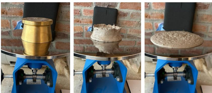
**Figura 4.5.5.** Foto à direita do teste de espalhamento do cone metálico cheio com a argamassa.
