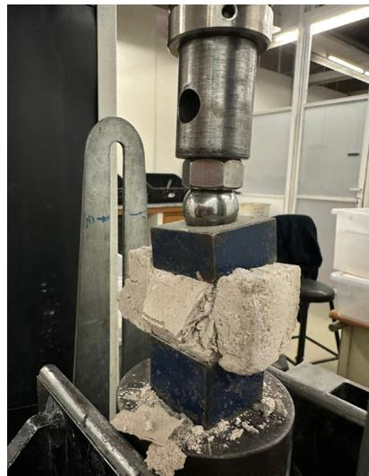
**Figura 4.5.13.** Foto à esquerda, início do teste à compressão de um provete.
