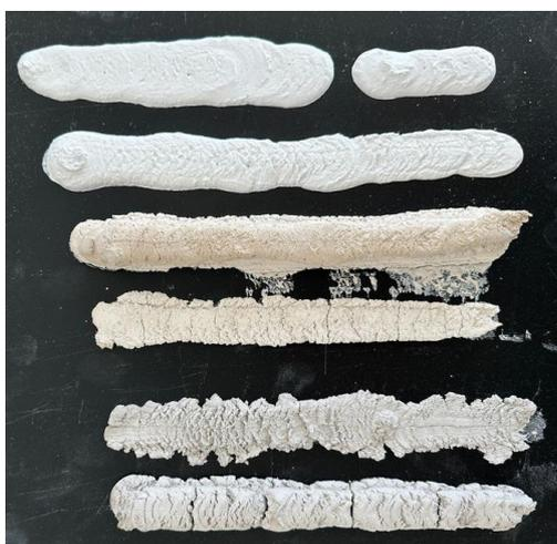
Este primeiro teste verificou-se bastante animador, havendo resultados, ao nível da consistência das camadas impressas, aparentemente positivos, e até da própria espessura e trabalhabilidade da argamassa.
