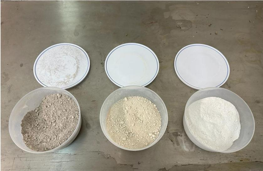
**Figura 4.3.2.** Foto de amostras secas de lamas de granito, calcário e mármore, respetivamente.
