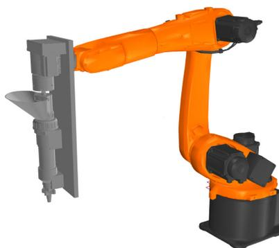
**Figura 3.5.1.** Foto à esquerda: Ferramenta extrusora de fuso
