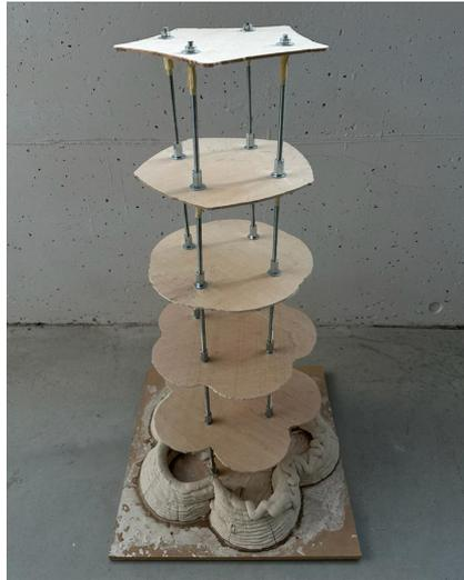
**Figura 5.3.6.** À esquerda, fotografia da interrupção da impressão da coluna, devido ao colapso do objeto impresso.
