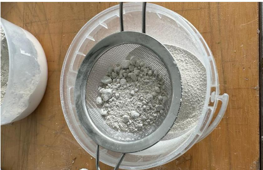
**Figura 4.3.4.** Foto de peneiração das amostras moídas.
