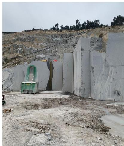
Nas centrais de extração (pedreiras) a pedra natural pode ser subtraída do solo maioritariamente de duas formas, ou pelo recurso a explosivos (que se executa normalmente em britadeiras pois a pedra é fragmentada e irregular Figura 2.2.1.) ou cortada com cabos diamantados extraindo blocos de pedra que se tornam convenientes para serem transformados em fábrica, por serem o mais paralelepípedicos possível, minimizando assim o desperdício (Figura 2.2.2.).
