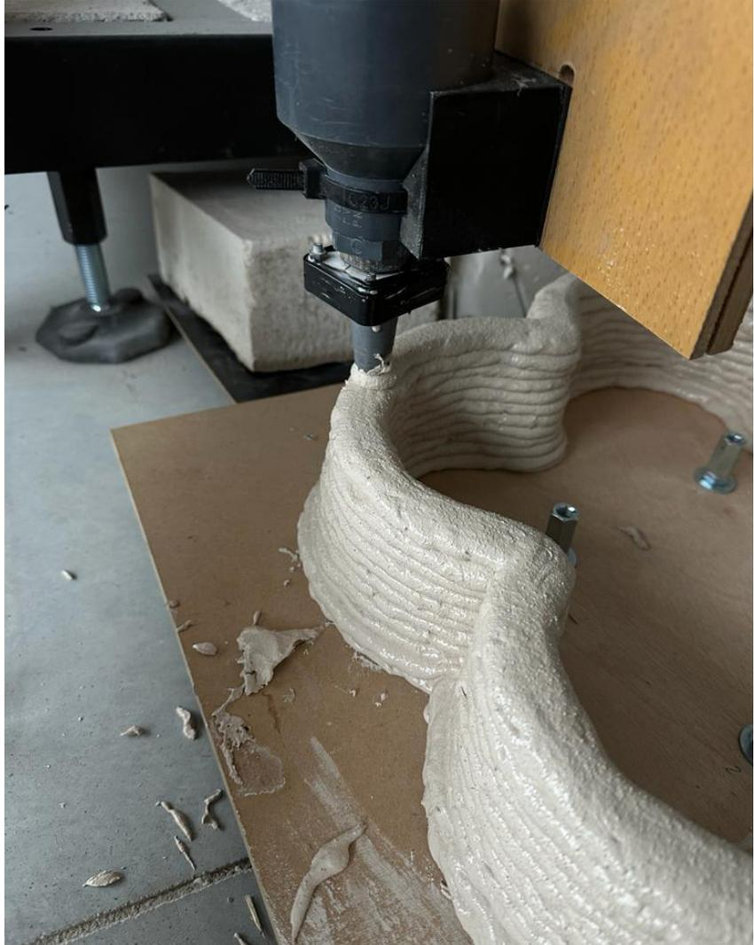
Não houve problemas com a impressão nas primeiras 9 *layers*, mas após estas, o material começou a ceder sobre o próprio peso (figura 5.3.6.) e a impressão foi interrompida, resultando num teste falhado, mas importante para decisão da próxima metodologia de impressão.
