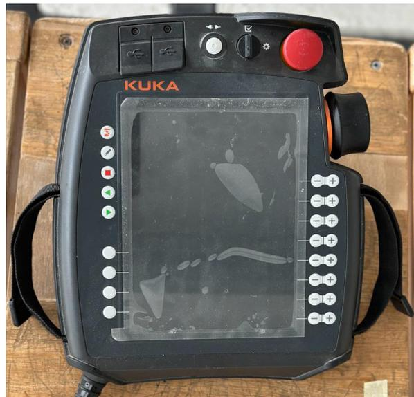
Este controlador acima, serve como meio de comunicação entre o robô e o utilizador nas diversas fases de execução, antes, durante e após o trabalho com o equipamento. É a partir dele que existe a possibilidade de mover os eixos do robô manualmente, ou selecionar e executar ficheiros previamente criados e exportados do KUKA|prc.
