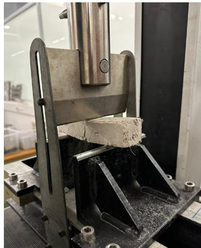
**Figura 4.5.11.** Foto à esquerda, início do teste à flexão de um provete.
