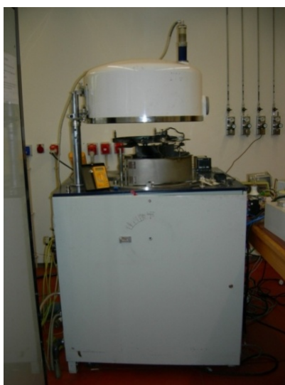
Figura 6.1: Evaporador térmico utilizado para depositar eléctrodos metálicos na superfície dos filmes de PVDF.
