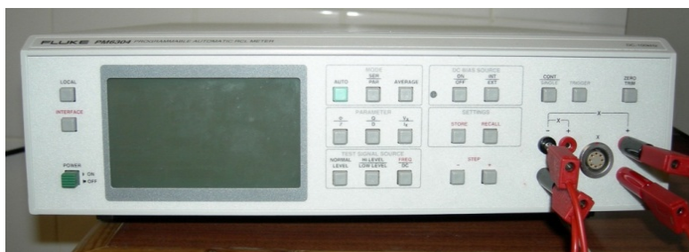
Figura 6.5: Medidor de impedâncias RCL utilizado para determinar a capacidade e o factor de perdas das amostras.
