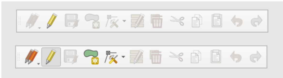
Figura 19: Ferramentas de alteração de formas: antes de ativar a edição (cima) e após ativar o modo de edição (baixo)
