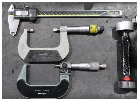
*Figura 33 - Instrumentos de medição/ calibração utilizadas na fase de verificação da peça.*
