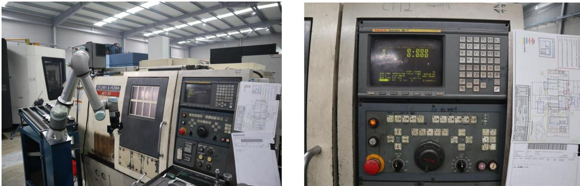
Figura 29 - Máquina-ferramenta Okuma & Howa act -20 e o respetivo controlador FANUC serie t-18.
