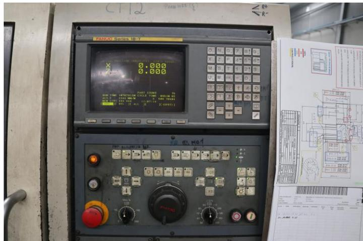
Figura 40 - Controlador CNC Fanuc Serie 18-t.
