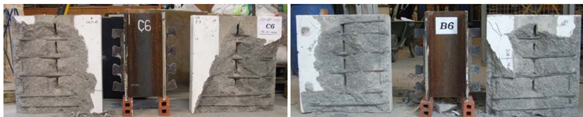
Figura 9 - Ruptura típica pela face interna das lajes nas séries A, B, e C.
