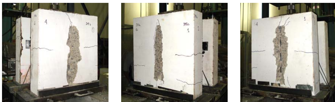
Figura 10 - Ruptura típica pela face externa das lajes na série D.
