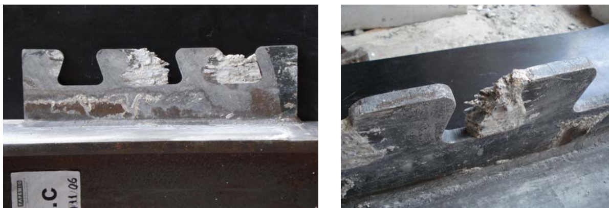
Figura 12 – Aspecto do concreto compactado no interior dos dentes do conector, após o cisalhamento em dois planos de corte.
