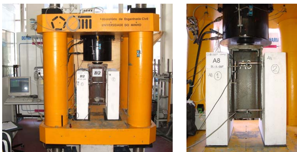
Figura 6 - Estrutura de reação e instrumentação para o ensaio tipo push-out .
