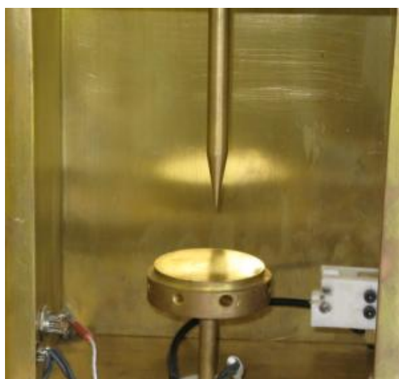
Figura. 6.4. – Montagem experimental para descarga de corona simples ( d_p=2\text{cm} ).
