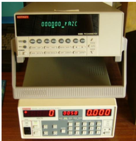
Figura. 5.7. – Picoamperímetro Keithley 6485 e fonte de alta-tensão Keithley 248.
