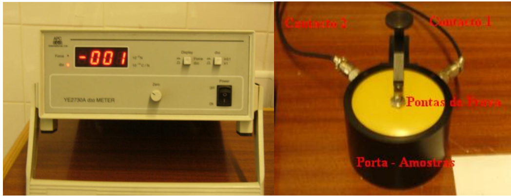
Figura. 6.5. – d_{33} meter APC YE2730A com porta-amostras. O porta-amostras é composto pelos contactos que controlam a força e frequência da força aplicada (contacto 1) e o sinal eléctrico obtido nos terminais das pontas de prova (contacto 2).
