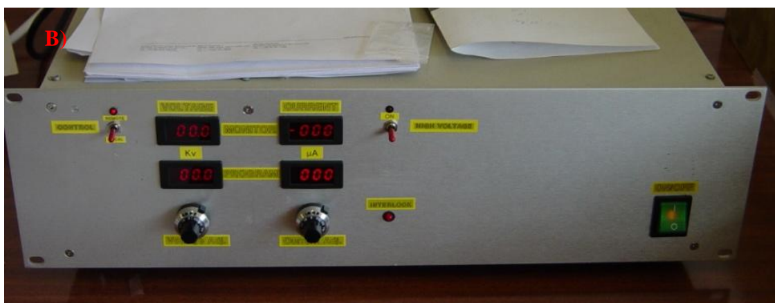
Figura. 5.6. – A) Fonte de alta-tensão Spellman SMS 300W; B) Sistema de controlo de tensão e corrente e sistema de controlo de descarga integrado.
