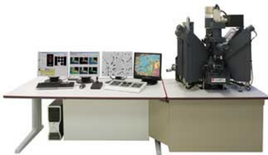
Fig. 3.1: Micro-sonda electrónica - EPMA (modelo Cameca SX-50) com o respectivo sistema de aquisição e tratamento de dados
