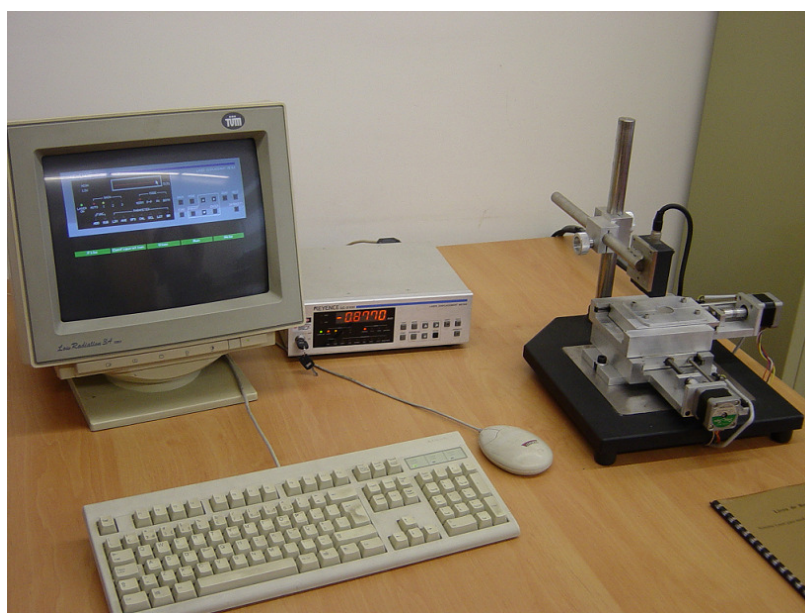
Fig. 5.3. Equipamento usado na determinação dos raios de curvatura do substrato antes e após a deposição do filme.
