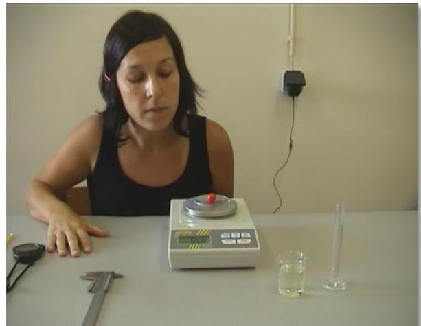
Figura 11 - Imagens dos planos 2 e 3 – Medição do diâmetro da esfera e Medição da massa da esfera
