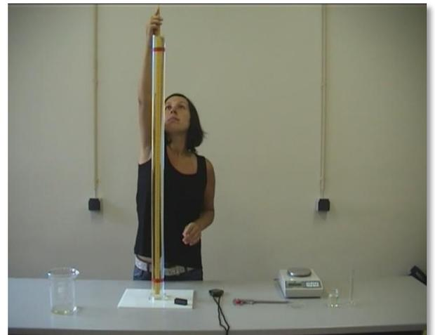
Figura 12 - Imagens dos planos: 4 – Encher o tubo; 5 – Definição do ponto inicial do percurso; 6 – Definição do ponto final do percurso e 7 – Medição da temperatura do fluido.
