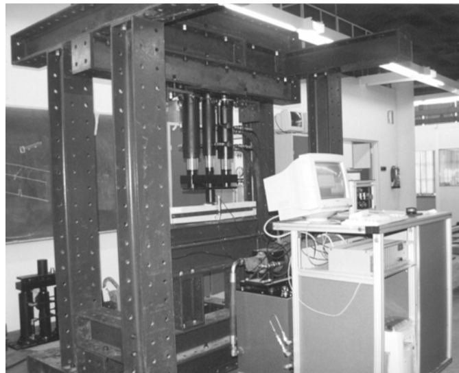
Figura 7 – Equipamento e sistema de reacção utilizado nos ensaios de flexão propostos pelo RILEM.
