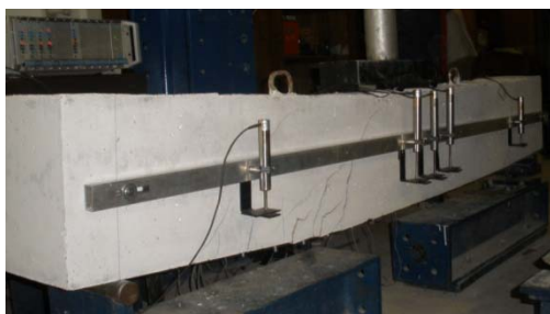
Figura 8. Modo de rotura do laminado MDL-CFRP na viga MF-EBR: (a) aspecto global da viga; (b) e (c) pormenores do esmagamento do laminado.
