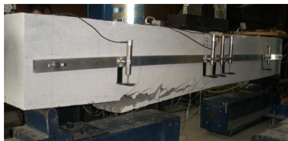
Figura 7. Modo de rotura do laminado CFK na viga NSM.
