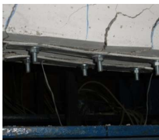
Figura 8. Modo de rotura do laminado MDL-CFRP na viga MF-EBR: (a) aspecto global da viga; (b) e (c) pormenores do esmagamento do laminado.
