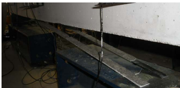
Figura 6. Modo de rotura do laminado CFK na viga EBR.
