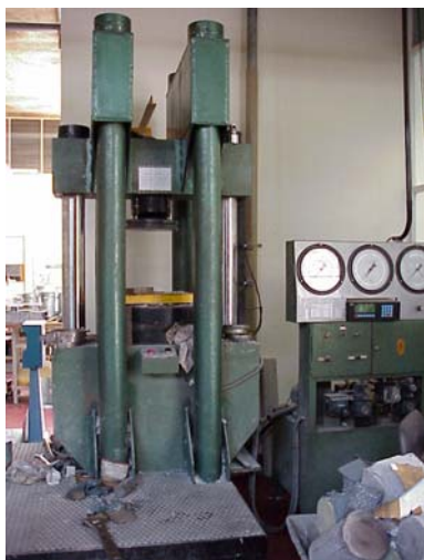
Figura 3.3 – Prensa de compressão uniaxial utilizada no grupo de ensaios C23S300
