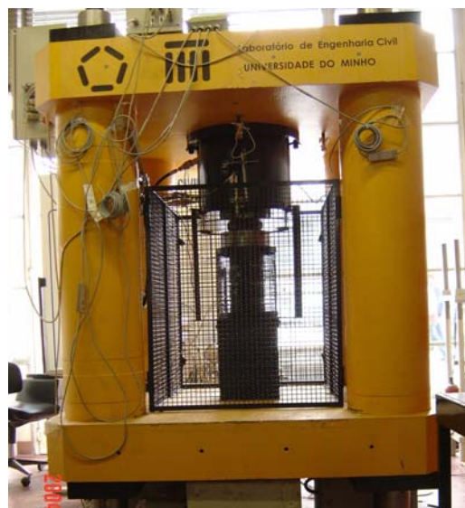
Figura 3.4 – Bastidor de ensaios à compressão uniaxial utilizados nos grupos de ensaios C23S200, C16S200 e C16S300.
