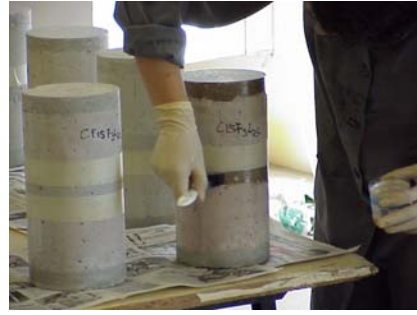
Figura 2.11 – Aplicação do primário.
