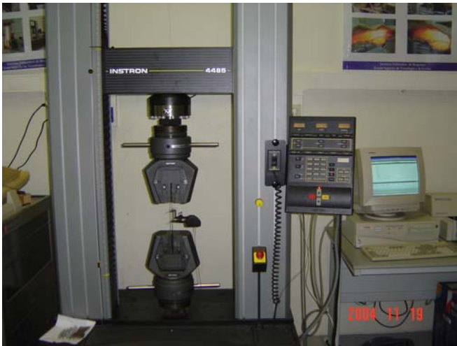
Figura 2.5 – Prensa servo-controlada, INSTRON modelo 4485.
