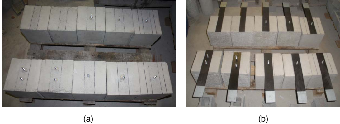
Figura 4. (a) Aspecto dos provetes após aplicação das ancoragens; (b) Aspecto dos provetes após aplicação do MDL-CFRP.
